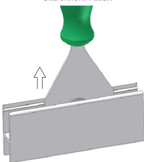
① La clé de montage s'enclipse entre les pattes de fixation en acier à ressort.
